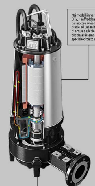
Nei modelli in versione DRY, il raffreddamento del motore avviene grazie ad una miscela di acqua e glicole che circola all'interno di uno speciale circuito chiuso.
